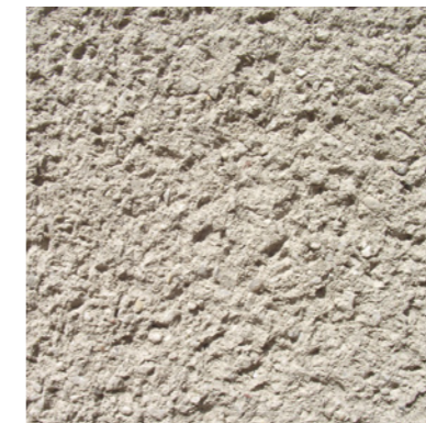
Optosan KratzPutz o strukturze cykliny - „drapanego baranka”
